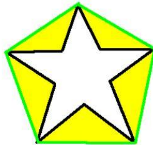
Gambar 2.12 Area yang berwarna kuning mewakili convexity defect [33]
